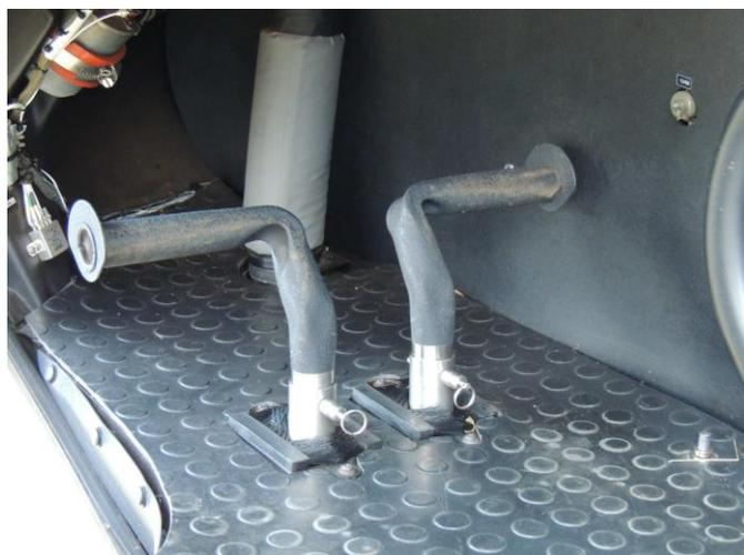
Figura 5: Pedais de comando do rotor de cauda.
